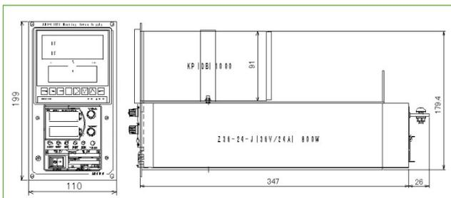
専用加熱電源 (AHP-801VTP) 外観寸法図
