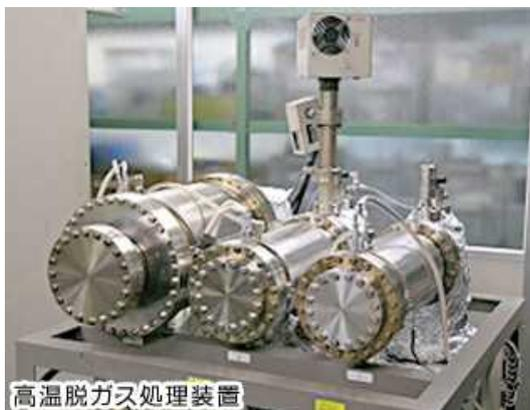
高温脱ガス処理装置
