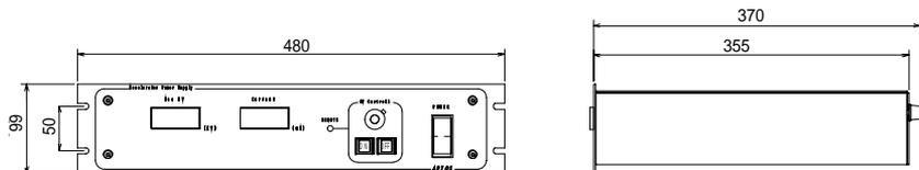
2kVイオン加速電源 (オプション) 外觀寸法図
