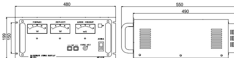
MP-201B 200Wマイクロ波電源外觀寸法図
